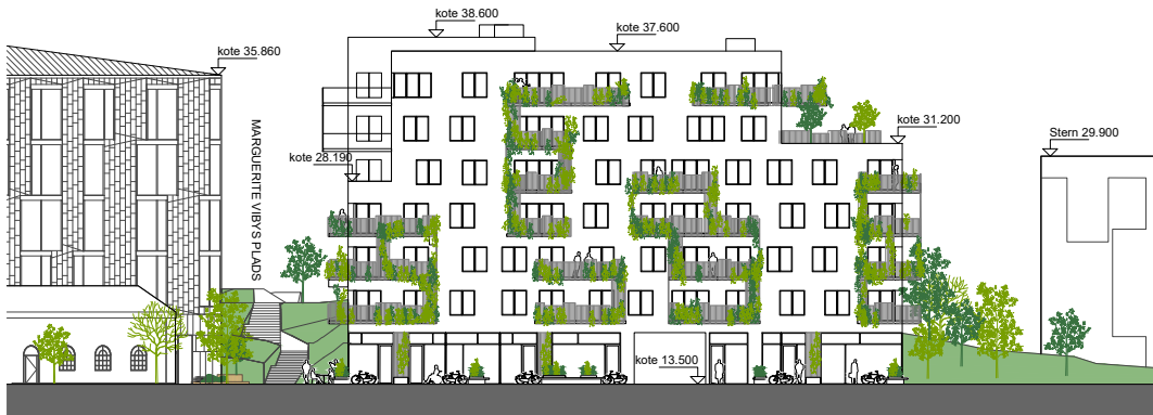
Facadeprincip mod Dirch Passers Allé af boligbyggeri i op til 7 etager. Målerhus og kontorbyggeriet til venstre i billedet og KU.BE ses til højre hvor indgangen til parken ligger. Byggeriet tilpasses de omkringliggende bebyggelser med nedtrapninger i ender og hjørnet mod Marguerite Vibys Plads. Adgang til P-kælder optages i bygningen.
