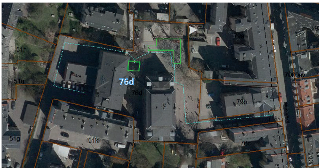
Illustration: Regnvandsanlæg ejet af Frederiksberg Kloak A/S efter aftale med grundejer. Blå streger ledninger og rørbassin. Grøn streg bassin under jord. Hertil kommer bassin på overfladen, som ikke er vist.
