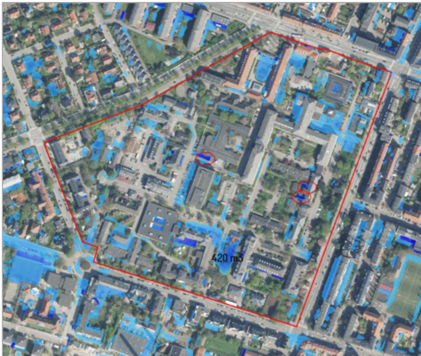
Figur 12-1 Viser oversvømmelser under ekstremregn (T100) vha. Scalgo. Hospitalsområdet er markeret med en rød linje.
