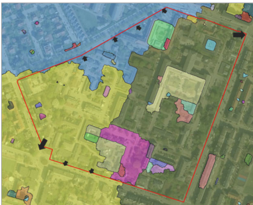
Figur 12-2 Kortlægning af strømningsveje og vandoplande for en fremtidig 100 års regn med det nuværende kloaksystem i Scalgo.
