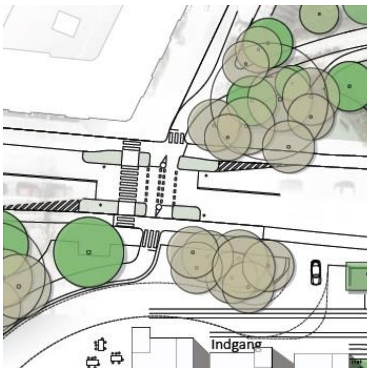
Principskitse for ny indkørsel til DST, samt stikrydsning på Peter Bangs Vej.
