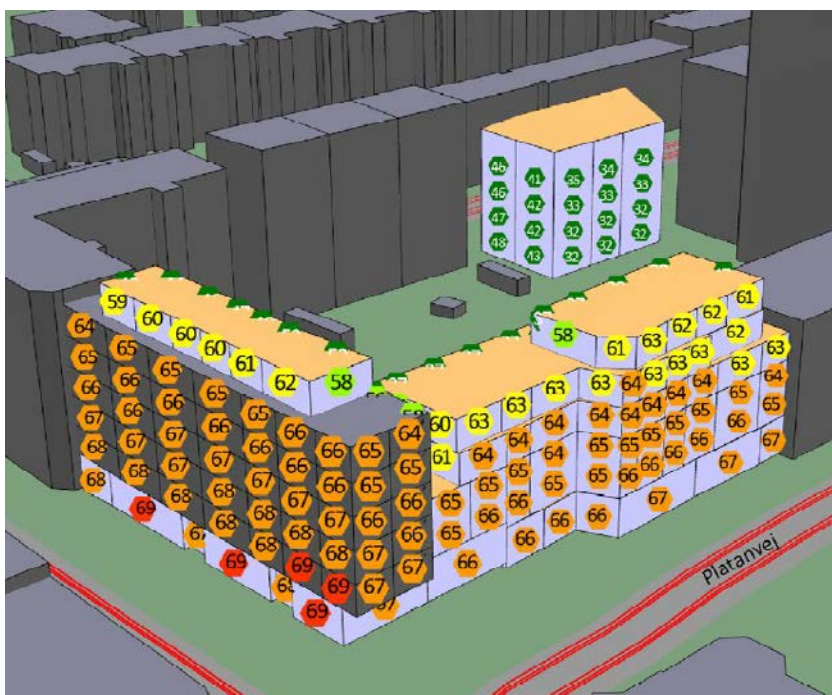
3D-kort med angivelse af facadestøjniveauer i dB (Lden) set fra sydøst.
