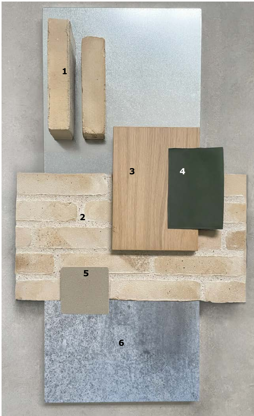
Materialepalette - 1) teglsten i lyse gule nuancer, i form af hånd- og sandstrøget mursten med et afstemt spil i sorte og rosa nuancer 2) lyse fuger, 3) egetræ 4) stof i Frederiksberggrøn 5) Indfarvet beton og 6) zink (zinkplade vil efter få uger fremstå med mat patineret overflade)
