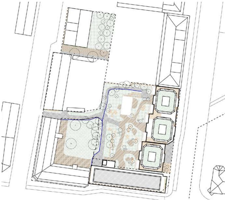
Situationsplan fra biofaktorberregning, jf. Bilag 10. I dag er ca. 70 % af gårdrummet 'grå' med biografbygningen og asfalterealer. I projektet er 60-70 % 'grønt'.
