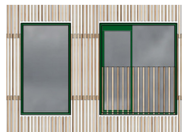
Figur 2: Vinduer og døre udføres i træ/alu med udvendigt alu-profil i mørk grøn farve.
