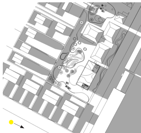
Skyggediagram d. 21. juni kl. 19.00. Bygningens skygge falder på Duevej og mod nabobebyggelser.
