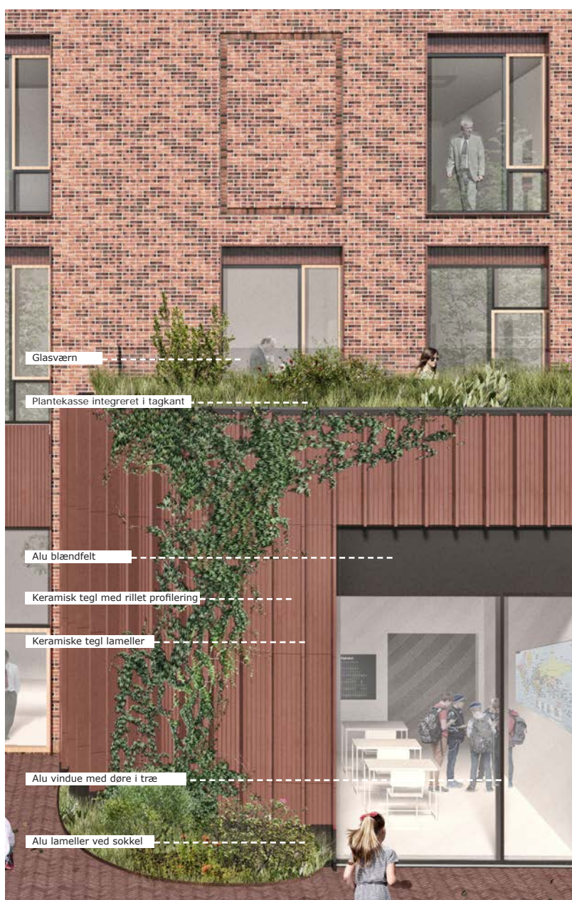
Facadeudsnit stueetage / base med keramisk beklædt facade med tilhørende snit 1:75
