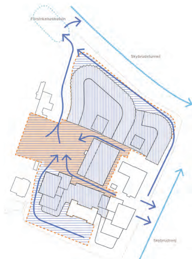
Endelig afledning af skybrudsvand til forsinkelsesbassin og herfra videre til skybrudstunnel i Boulevard og skybrudsvej på Bülowvej
